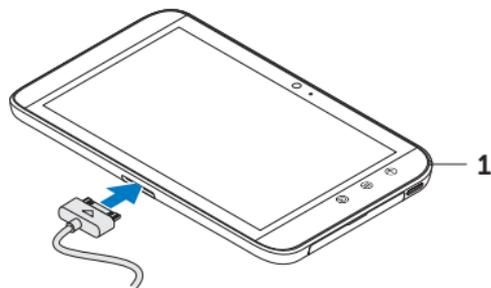
1 Indicatore di stato della batteria
